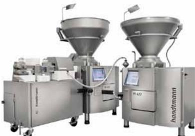
Die Handtmann Maschinenfabrik ist Weltmarktführer bei Maschinen zur Wurstherstellung. Das vollautomatische System stellt ohne Unterbrechung einzelne Würstchen oder Wurstketten
